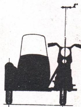
Агрегат следует поставить на ровную в горизонтальном отношении поверхность размером около  $2,5 \times 2$  м. Для регулировки используйте две ровные планки длиной около 2,5 м.
